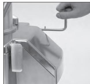
**②** Вставьте **стержень шарнира** в предусмотренное для него место сзади моторного блока.
