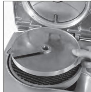
Установите затем соответствующий диск измельчитель (диск с прямым ножом) и прокрутите его в направлении часовой стрелки, чтобы проверить правильность его установки.
