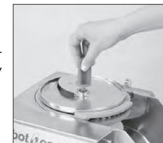
**③** Зафиксируйте смеситель винтом на валу двигателя.
