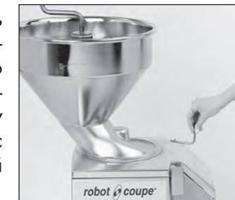
**⑤** Вставьте стержень шарнира в предусмотренное для него место сзади блока. Заблокируйте затем крышку на валу двигателя с помощью крепежной лапки.
